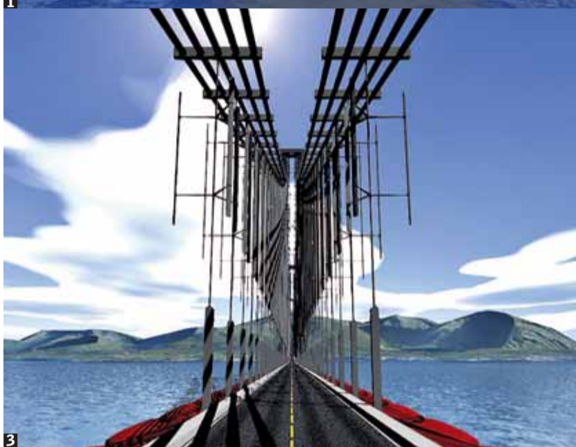
1. Bruprosjektet ser både på flytebru og hengebrumodeller. 2. En bru mellom Snarset i Bø og Dragnes i Hadsel er utgangspunktet for prosjektet. 3. Vertikale vindmøller, slik vi ser langs sidene, er forholdsvis uprøvd i Norge. 4. Undervannsturbiner foreslås på broer over havstrekninger med sterke strømninger. ILLUSTRASJONER: NORNET.NO
